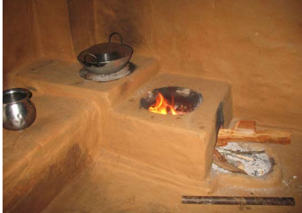
Meist verfügen die neuen Kochöfen über zwei Kochstellen und können unter der Anleitung von Experten mit Lehm aus der Umgebung selbst gebaut werden. Das ist preisgünstig und erleichtert die Umsetzung
